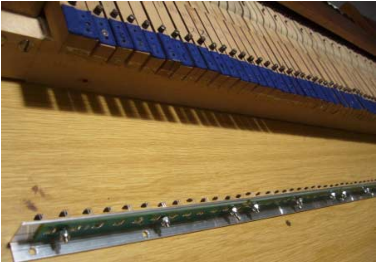
Die fertige Hall-Schiene vor der Montage an die Klaviatur.
